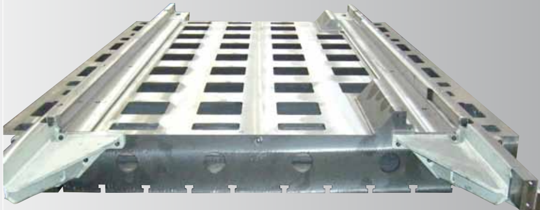
Machine table, 4.000 x 3.000 x 470 mm for a milling machine
